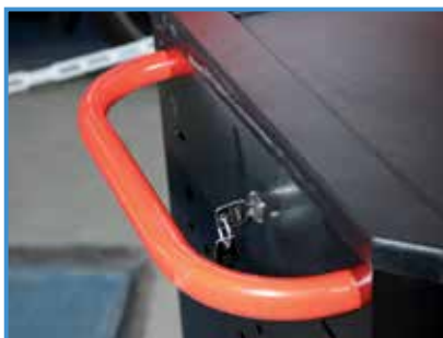
Sécurité des équipements : fermeture centralisée des tiroirs avec une serrure unique.
