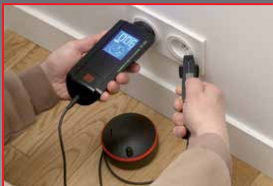
Contrôle de continuité entre prises.
