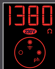
Exemple d'affichage d'une installation avec mauvaise terre : réseau 230 V, phase à droite, valeur de terre >100 \Omega .
