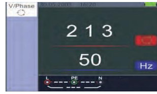
Afbeelding 24: Fasevolgorde verkeerd aangesloten in de tegengestelde richting van de klok.
