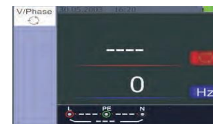
Abbildung 21 Erster Bildschirm der Phasenfolgemessung
