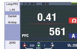
Abbildung 9 - Hi Amp LOOP-Messung abgeschlossen
