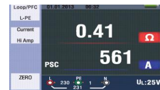
Figure 13 Impédance de ligne L-N - Mesure terminée
