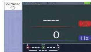
Figura 21 Pantalla de inicio de la medición de secuencia de fase
