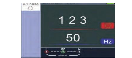
Figure 23 Écran de séquence de phases - lorsqu'il est connecté dans le sens des aiguilles d'une montre.
