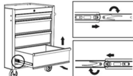
Remise en place des tiroirs : tirer les glissières et le support de glissière vers l'extérieur jusqu'à ce qu'ils soient complètement sortis. Tenir la glissière du tiroir tout en l'alignant sur la glissière de la servante. Insérez légèrement un côté et répétez l'opération pour l'autre côté. Poussez lentement le tiroir jusqu'à ce qu'il soit complètement fermé pour engager la glissière. Ouvrez et fermez le tiroir pour vérifier son bon fonctionnement.
