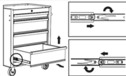
Reinserción de los cajones: tire de las guías y del portaobjetos hasta que estén completamente extendidos. Sujete la guía del cajón alineándola con la guía del mueble. Introduzca ligeramente un lado y repita para el otro lado. Empuje lentamente el cajón hasta que esté completamente cerrado para encajar la guía. Abra y cierre el cajón para verificar su correcto funcionamiento.
